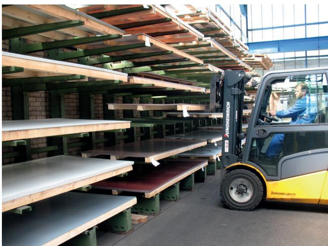
Beschichtete Aluminium-Flachbleche, eins. 25 µm Polyester Beschichtung mit Folie, Rückseite Schutzlack
