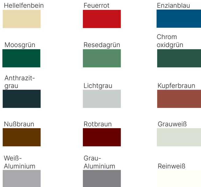
Verzinkt-beschichtete Stahl-Flachbleche, eins. 25 µm Polyester Beschichtung mit Folie, Rückseite Schutzlack
